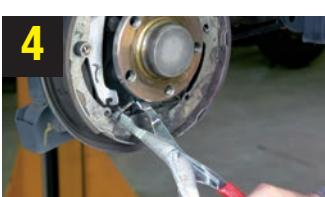
Da bi se izbeglo oštećenje komponenti, uvek koristite odgovarajuću posebnu alatku za ugradnju / uklanjanje **kabla ručne kočnice**
