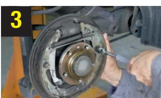
Da bi se izbeglo oštećenje komponenti, uvek koristite odgovarajuću posebnu alatku za ugradnju / uklanjanje **povratne opruge**
