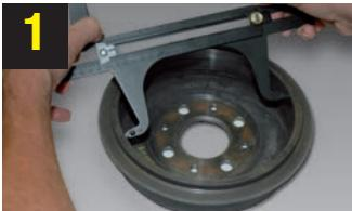
Pregledajte doboš kočnice na prisustvo habanja i oštećenja. Izmerite prečnik. Nova dimenzija, plus prečnik od maks. 0,5 mm može da se koristi samo sa oblogama za doboš kočnice prekomerne veličine. Ležajevi točka i/ili prstenovi senzora takođe treba da budu zamenjeni, u zavisnosti od verzije.
