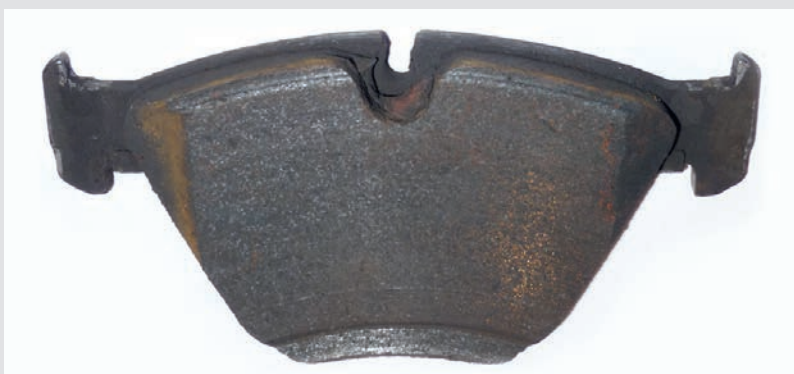
► Neujednačeno trošenje kočione obloge.
