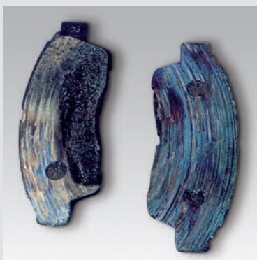
► Frikcioni materijal istrošen skroz do metalnog nosača
