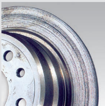
► Kočioni diskovi oštećeni istrošenim frikcionim materijalom
